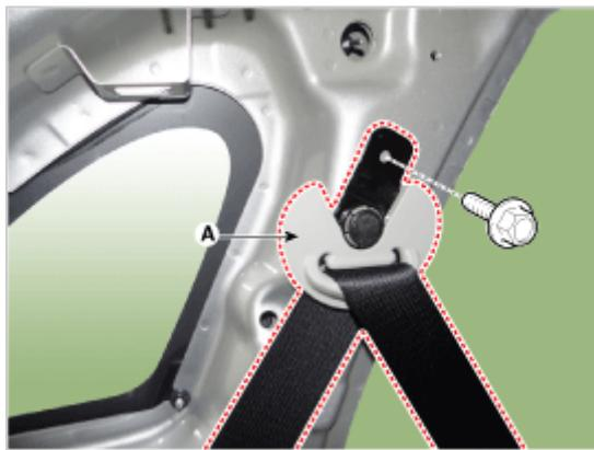
3. 拧下固定螺栓，并拆卸后座椅安全带卷带器(A)。
